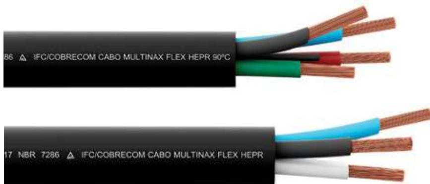
Para tensões nominais até 0,6/1 kV, formado por fios de cobre nu, eletrolítico, têmpera mole, encordoamento classes 4 e 5 (flexíveis), isolado com composto termofixo Etileno Propileno (HEPR), de alto módulo para 90 °C, veias torcidas entre si, formando o núcleo, a cobertura extrudada com Policloreto de Vinila (PVC), tipo ST 2, antichama (BWF-B).
