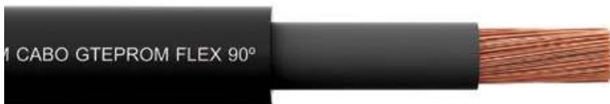
Para tensões nominais até 0,6/1 kV, formado por fios de cobre nu, eletrolítico, têmpera mole, encordoamento classe 5 (flexível), isolado com composto termofixo Etileno Propileno (HEPR), tipo alto módulo para 90 °C e cobertura de Policloreto de Vinila (PVC), ST 2 antichama (BWF-B).
